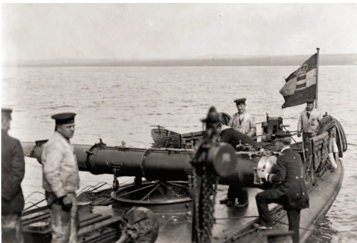
Fig. 5 - Vista d'insieme di un tubo lanciasiluri poppiero imbarcato su una torpediniera austro-ungarica [archivio Nicola Ragnoli].
