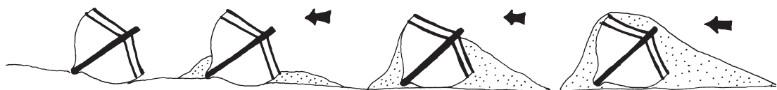
Fig. 4 – Effetto-trappola operato dal relitto sui sedimenti in movimento sul fondale (G. Boetto).
